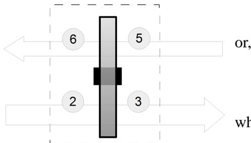
$$\dot{m}_{da,2} h_2 + \dot{m}_{da,5} h_5 = \dot{m}_{da,2} h_3 + \dot{m}_{da,5} h_6$$
